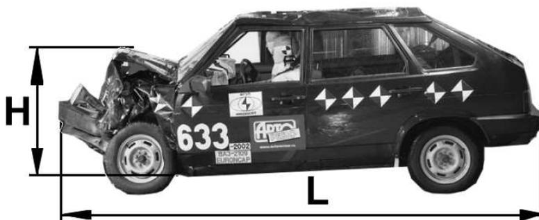
Рис. 1. Измерение длины и высоты кузова после удара
