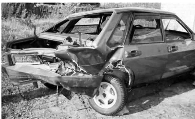
Рис. 6. Деформация автомобиля ВАЗ–21099
