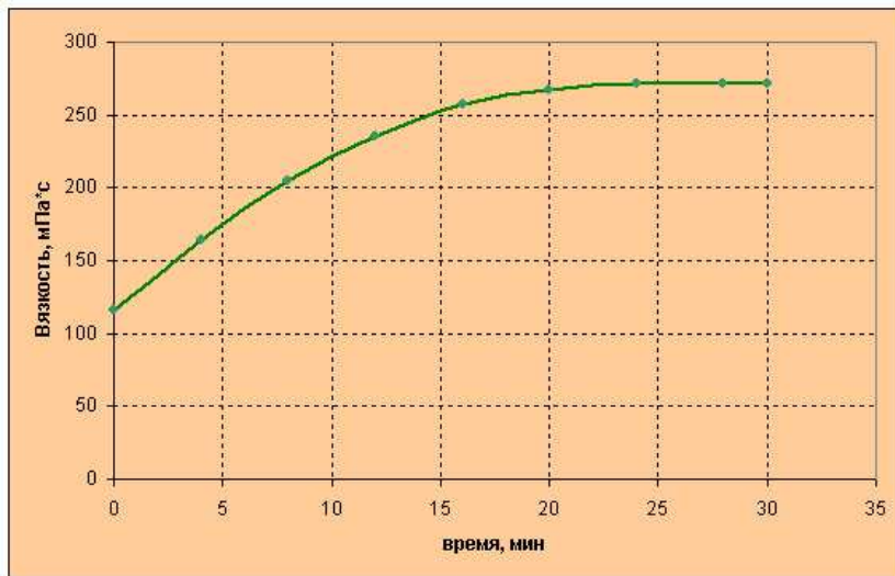
Рис. 8. Рост вязкости стабилизированной ВОВНЭ со временем при скорости деформации сдвига 900 1/с между конусом и пластиной (Реотест 2.1)
