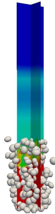
Рис. 1. Пример распределения гранулированной среды в нижней части ударной трубы
