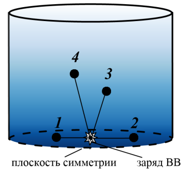
Рис. 1. Схема эксперимента: 1–4 — местоположения датчиков давления
