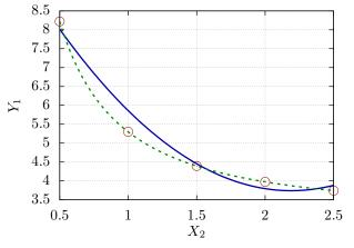
Рис. 3. Зависимость целевой функции от факторов  $X_1$  ( $x_2=0$ , сверху) и  $X_2$  ( $x_1=0$ , снизу). Символы — данные вычислительного эксперимента [26,31], сплошные линии — аппроксимация ОЦКП (9); пунктирные линии — асимптотическая интерполяция (13)
