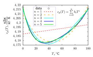
Рис. 1. Результаты аппроксимации МНК в *Scilab* с визуализацией в *Gnuplot*. Символы — экспериментальные данные [27], линии — аппроксимация (1)
