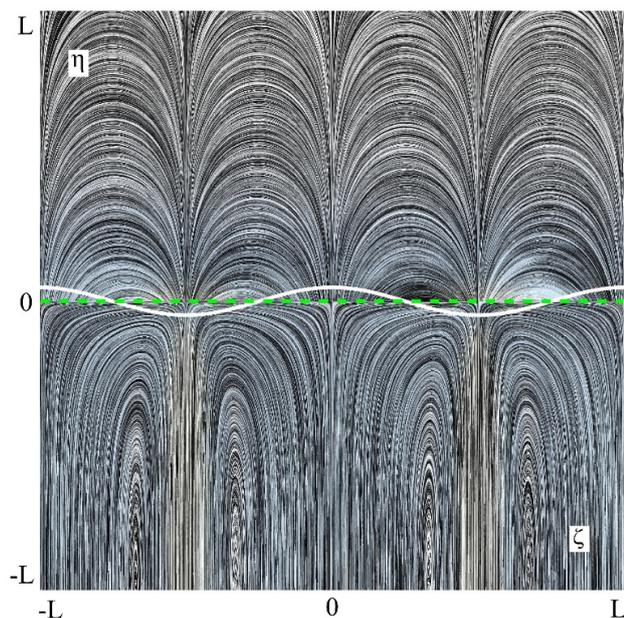
Рис. 1. Линии тока, соответствующие стационарному решению (4), построены для случая  $L = 10$ ,  $k = 2\pi/L$  и  $a^2 = (1 - k)/(1 + k)$ . Сплошная белая линия – фронт пламени. Зелёный пунктир – невозмущённое пламя
