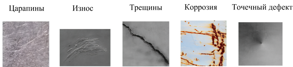
Рис. 2. Примеры наиболее распространённых типов дефектов УЭЦН
