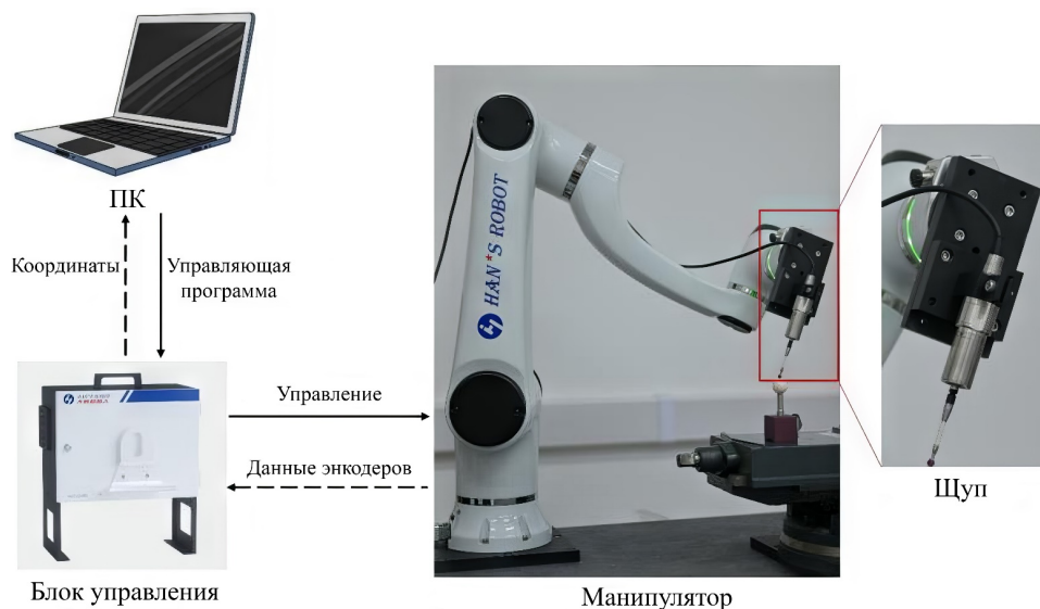
Рис. 3. Состав роботизированного измерительного модуля
