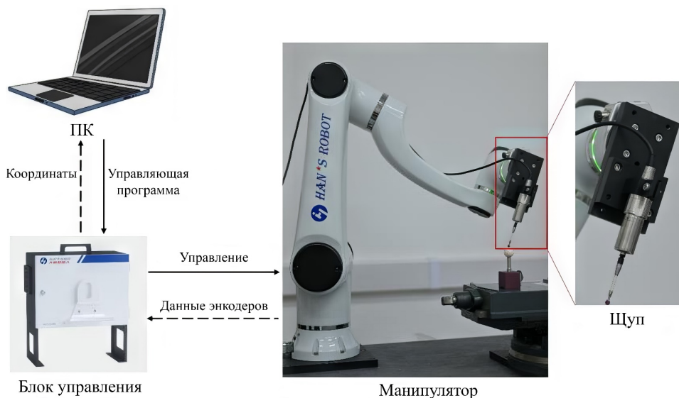
Рис. 3. Состав роботизированного измерительного модуля
