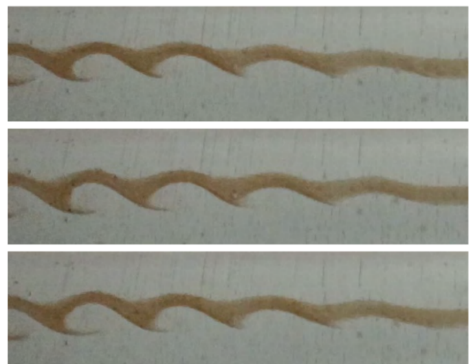
Рис. 8. Эволюция вихревых структур струи подкрашенного 45%-го раствора пропиленгликоля в потоке раствора 45%-го пропиленгликоля вдали от иглы при Re = 1800 , dT = 0\text{ }^{\circ}\text{C}
